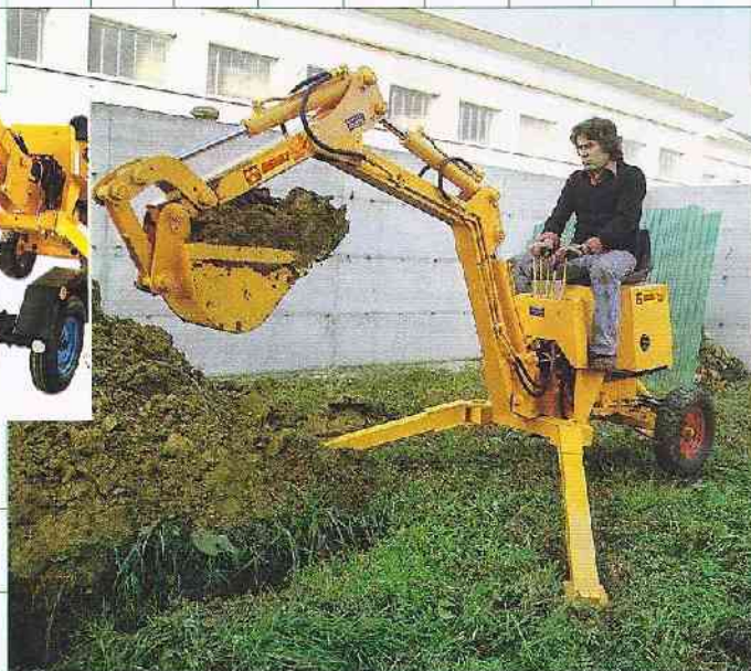
◀ Vanghe sulla staffa posteriore Hintere Stützfüßen Back support for spades Beche sur l'étrier postérieur
