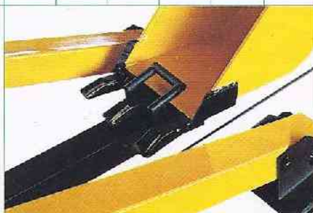
◀ Aggancio della benna al carrello Löffelbefestigung auf dem Spezialanhänger Coupling of bucket to truck Crochet sur le remorque
