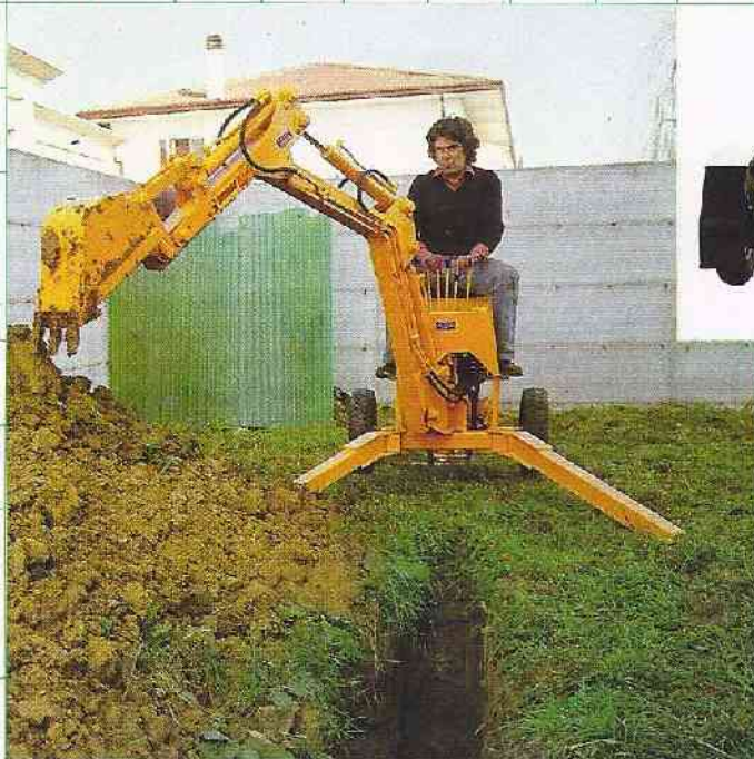
◀ Scarico laterale 130° Seitenschwenkung Side unloading Décharge latérale
